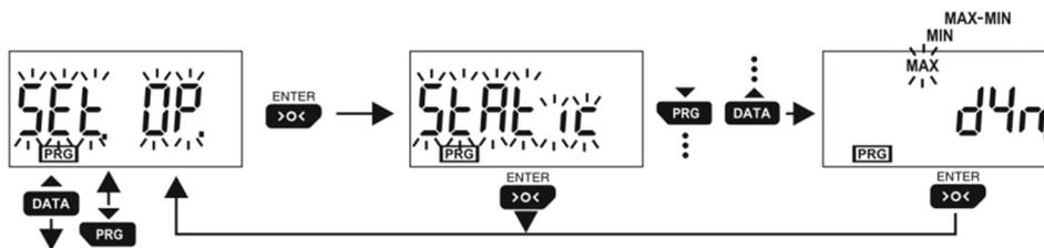
Abbildung 5: Messmoduswechselmenü im Sensor Display SD1
